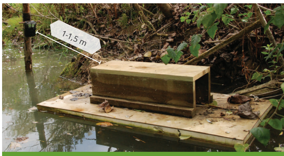
Figura 4. Cámara combinada con plataforma flotante en el río Tirón (acción A1).
