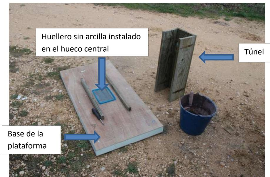
**Figura 1.** Plataforma flotante antes de su montaje final (antes de colocar el túnel y cubrir la esponja del “huellero” con la mezcla de arcilla refractaria y arena).
